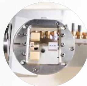
**C-Clamp pallettizzabile**, consente la lavorazione della zona vestibolare, il supporto è adatto ad essere montato nel magazzino caricatore
