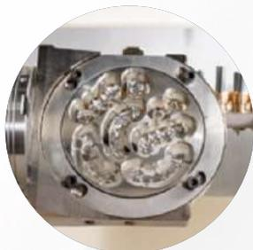
**Supporto chiuso ad alta rigidità** per le lavorazioni di precisione su metallo, il supporto è adatto ad essere montato nel magazzino caricatore
